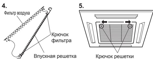
• Пыль можно удалить из фильтра воздуха или с помощью пылесоса, или промыв его в растворе мягкого моющего средства в теплой воде. Если фильтр помыт, прежде чем устанавливать, дайте ему полностью высохнуть в затененном месте.
